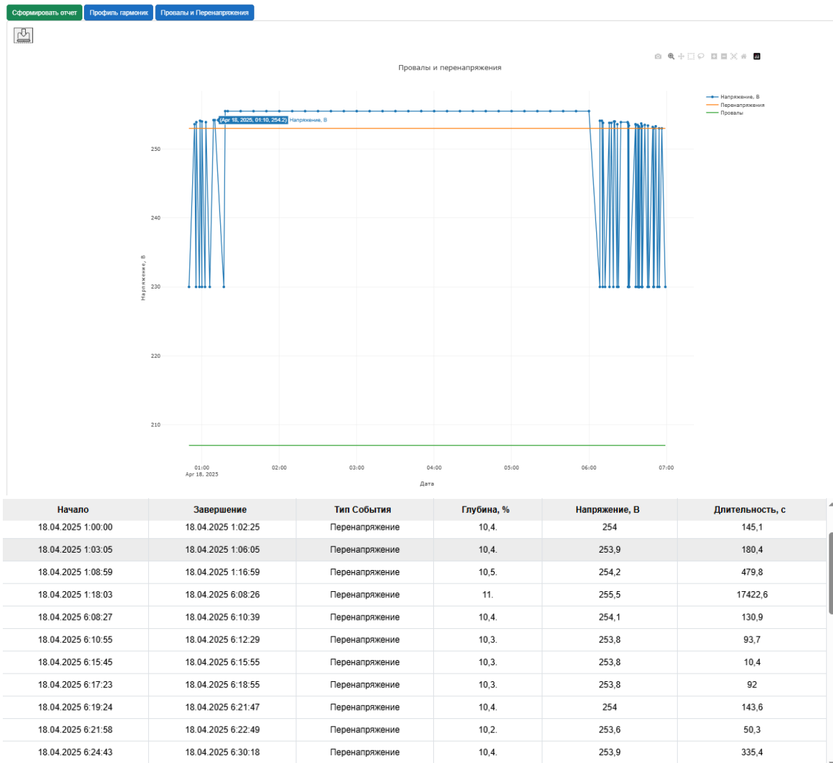
Рисунок 31 — Диалоговое окно подраздела «Качество электроэнергии» с открытой вкладкой «Провалы и перенапряжения»
