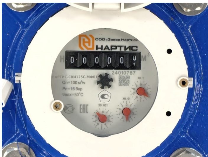
Рисунок 1 – Индикаторное устройство счетчика НАРТИС-СВИ
