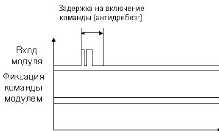
Рис. 3.7 Минимальное значение задержки на срабатывание входа
