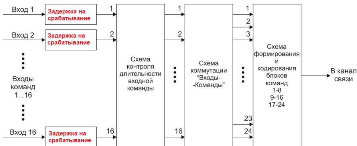
Рис. 3.4 Схема обработки дискретных входов
